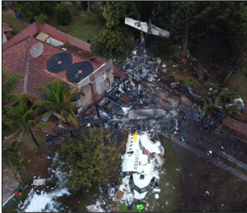
Figura 32 - Vista geral da aeronave após colisão com o solo e fogo pós-impacto.
